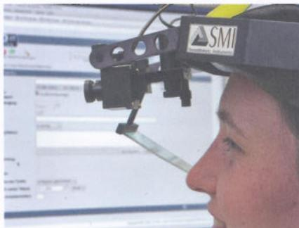
Mit dem Eyetracker können die Blickbewegungen der Software-Nutzer genau verfolgt und ausgewertet werden
